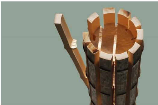
Die so gewonnen Rohlamellen werden weiter in Vierseiten Fräsen gesäumt und es entstehen gleichmäßig geformte Lamellen, die der Weiterverarbeitung zur Verfügung stehen.
